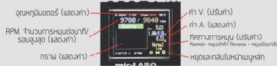
Program เป็นฟังก์ชันในการ Break-in โดยอัตโนมัติ โดยสามารถกำหนดแรงดันไฟฟ้า (V.), ก็อกการหมุน (N.R), เวลาดำเนินการ และอัตราเร่งที่ต้องการ สำหรับเวลา 5 ชั่วโมง สำหรับการหมุนแบบเดียว ไม่รวมการหมุนลดลง; RPM.
